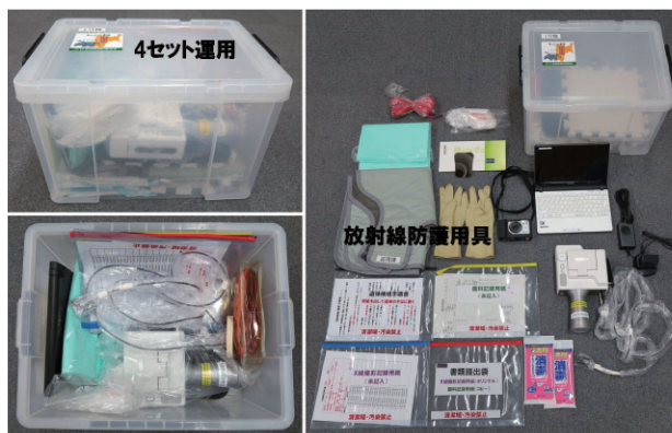
図1 歯科検死標準機材パッケージの整備 ①デンタルチャート、②防水・防塵・耐衝撃カメラ、 ③ポータブルX線撮影装置を含む
